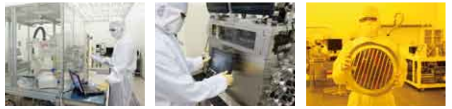
■西澤記念研究センターには、半導体メーカーと共同開発した8inch、12inchのLSI製造装置。このような最先端装置が、2013年完成予定の多賀城市の製造拠点に並ぶ
