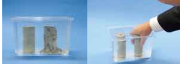
■研究室を訪れた人には、セメント固化処理土(右)とボンテラン処理土(左)の水の中比較などもデモンストレーション。水に対する強度の違いが明確になる
