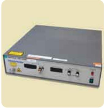
2004年に特許を出願(2005年に取得)し、2005年に共同開発した「ピコ秒光パルサー」は、5psの時間幅の超短光パルス発生を実現し、1kW超の高ピークパワー、50%超の効率での第2高調波(もとの半分の波長の光)変換を実現した超短光パルス光源です。簡単な電氣的パルス入力による半導体レーザーからのピコ秒光パルス発生技術と、光ノイズと非線形効果を抑制した光増幅技術の開発により、小型で高安定な高ピークパワー光パルスを発生することに成功したのです。
