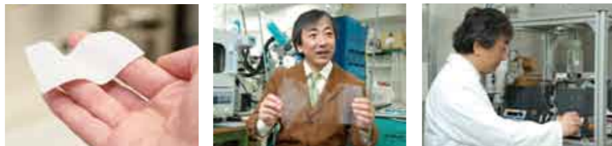
■セラミックス90%以上のプラスチック。車の電子機器などへの活用が考えられる ■ジルコニアが入っているのに透明、高屈折率の新しい素材 ■研究の出発点となった初期の「超臨界水熱合成装置」
