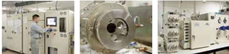
■量産を可能にする有機・無機ハイブリッド粒子超臨界ナノ粒子連続合成装置 ■初期の超臨界水熱合成と同じ原理で、反応を評価できる超臨界反応試験装置
