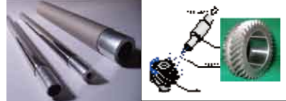
■GALOAは、鉄基、ニッケル基の金属ガラスを粉末にして火炎放射して成膜していくため、簡便で、比較的安価に、酸・アルカリの腐食に強く熱衝撃にも強いコーティングができる
