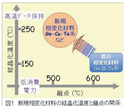
図1 新規相変化材料の結晶化温度と融点の関係
