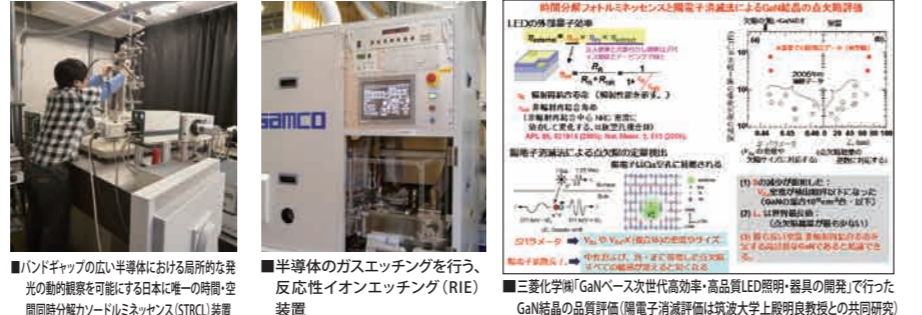
■バンドギャップの広い半導体における局所的な発光の動的観察を可能にする日本に唯一の時間・空間同時分解フォトルミネッセンス(STRCL)装置 ■半導体のガスエッチングを行う、反応性イオンエッチング(RIE)装置 ■三菱化学(株)「GaNベース次世代高効率・高品質LED照明・器具の開発」で行ったGaN結晶の品質評価(陽電子消滅評価は筑波大学上殿明良教授との共同研究)
